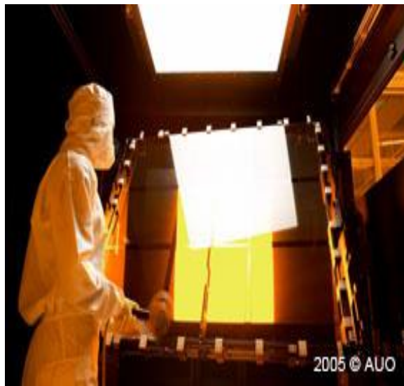
TFT 檢測臺，工程師正在透過機臺檢測玻璃基板光罩
