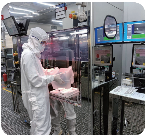
▲ 環球晶圓中德分公司在包裝站引入 AI 影像辨識系統，實現自動化檢測，減輕員工負擔。
