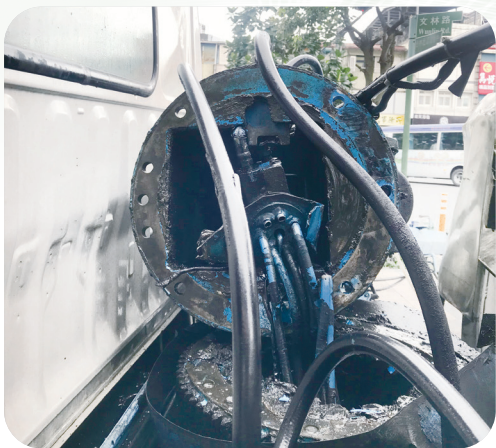
▲ 圖 2 支撐座螺絲全數斷裂
