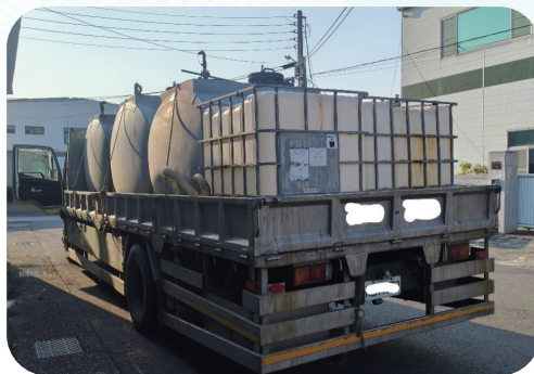
▲ 圖 1：B 公司勞工駕駛積載型卡車載運聚氯化鋁（即 PAC）、氫氧化鈉（即液鹼）、次氯酸鈉（即漂白水）等水溶液之容器，皆未規定明顯標示危害圖示與其內容。
