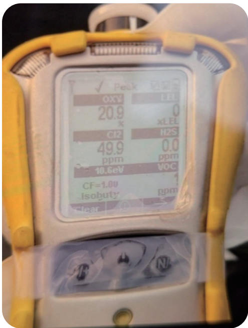
▲ 圖6：事發後A公司現場量測工作場所空氣中之氯氣濃度高達49.9 ppm。
