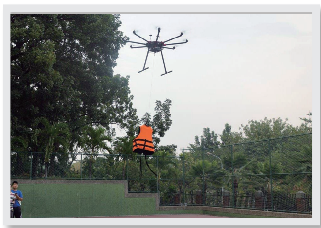
▲ 無人飛機吊掛救生衣之飛行測試
