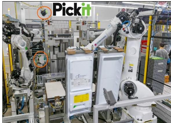
圖 2-5 使用 Pickit 3D 視覺系統裝附冰箱門
