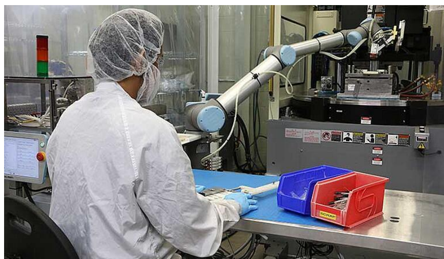
圖 3-13 協作型機器人操作完整的射出成型機械流程
