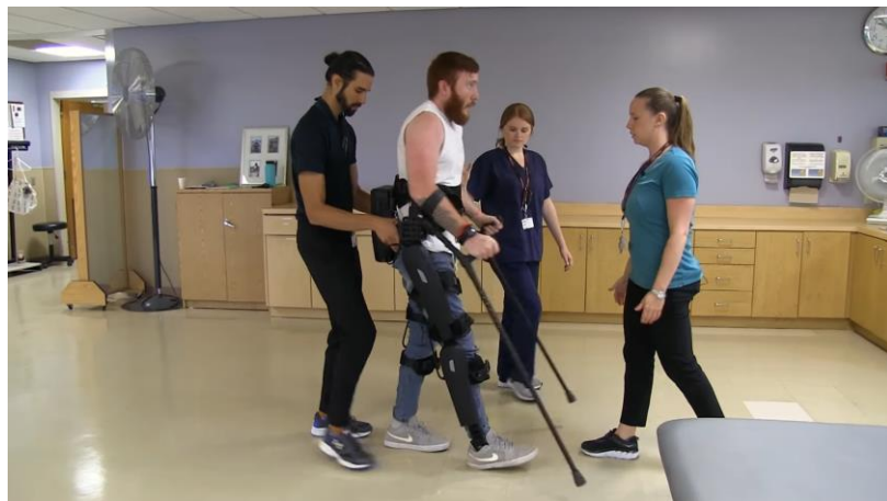
圖 2-15 ReWalk 穿戴式外骨骼
