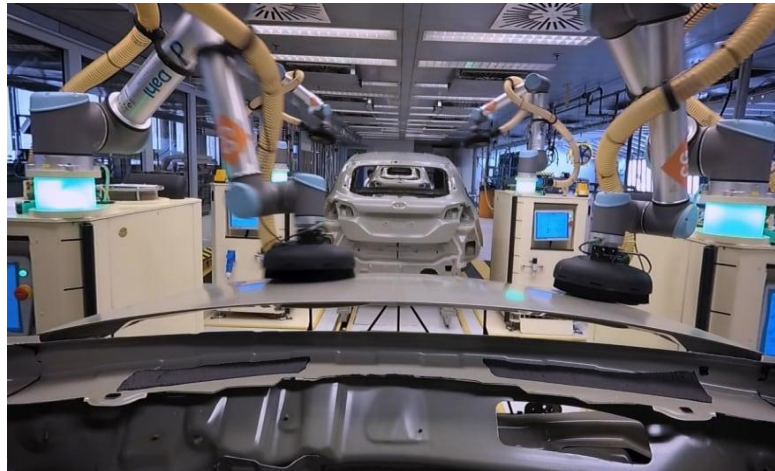
圖 3-2 協作機器人手臂在汽車生產線上，將汽車表面進行打磨
