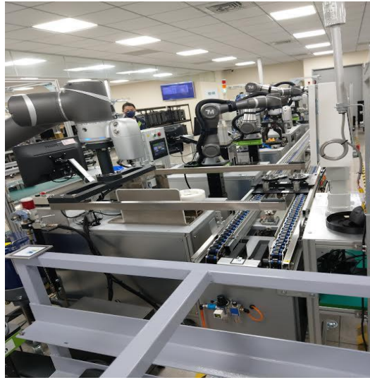
圖 3-15 生產機械手臂工件的自動化生產線
