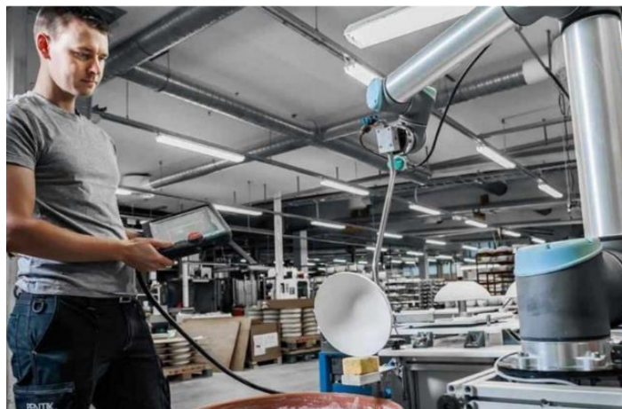
圖 3-5 操作員進行施釉塑型作業的測試
