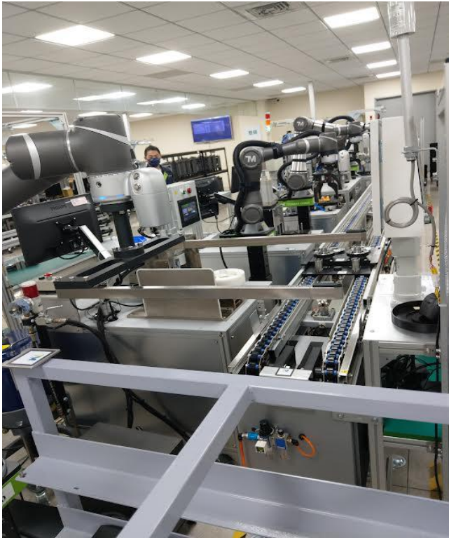
圖一 生產機協手臂工件的完整生產線
