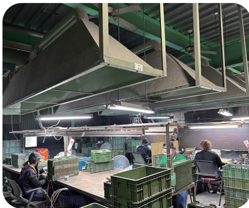
▲ 圖 4、手工研磨區加設個人工作桌及包圍式氣罩，避免勞工暴露化學品
