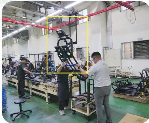
▲ 圖 3、使用客製化鈎具搬運時同時翻轉工件，避免勞工長期搬運之人因風險
