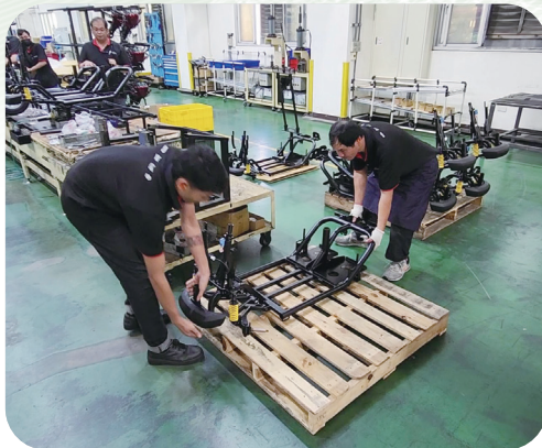
▲ 圖 3、使用客製化鈎具搬運時同時翻轉工件，避免勞工長期搬運之人因風險
