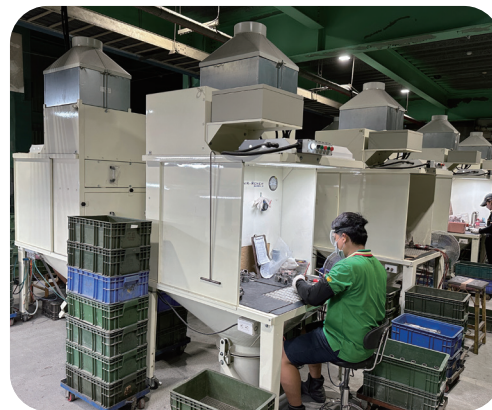
▲ 圖 4、手工研磨區加設個人工作桌及包圍式氣罩，避免勞工暴露化學品
