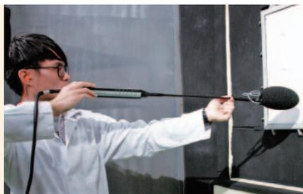
▲ 研究生利用九個不同測點測試隔音材料的穿透損失
