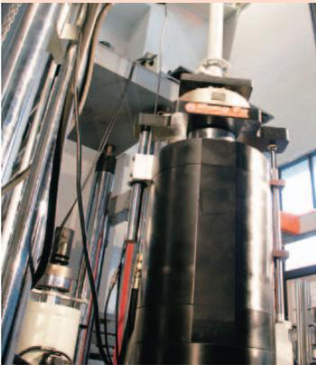
▲ 雙軸振動平台及動態測試驗機
