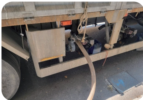
▲ 圖 3：B 公司積載型卡車所設泵浦與輸送軟管，皆未依規定明顯標示輸送物質名稱等資訊。
